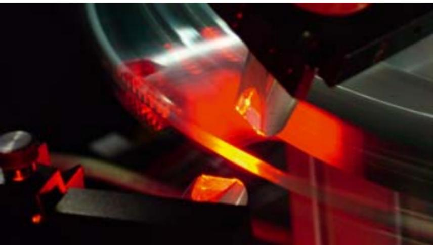
Die Inline-Inspektion von Draht ist nur ein Beispiel für den Einsatz einer neuen Kameraarchitektur basierend auf optischen Zellularen Neuronalen Netzwerken
