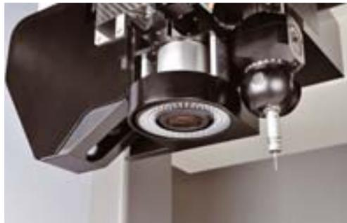
Dank der Multisensorfähigkeit kann das System unterschiedliche Formmessungen an Werkstücken durchführen
