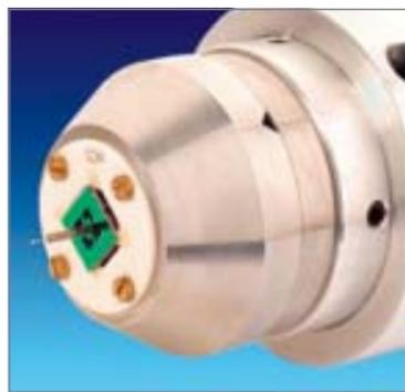
Die PTB stellt einen 3D-Mikrotaster für die dimensionelle Vermessung von Mikrostrukturen vor. Weil die Mikrotaster in einer neuartigen Wechseinrichtung auf den Tastköpfen sehr einfach ausgetauscht werden können, bestechen sie durch kurze Rüstzeiten. Zusätzlich ist der neue Mikrotaster präziser als bisherige Systeme. Um das zu erreichen, wurden bisherige Tastergeometrien entscheidend verändert.
