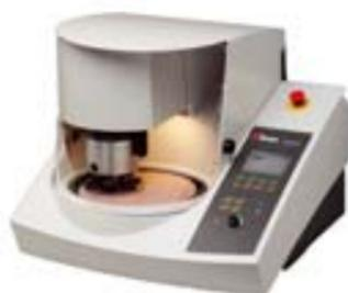
Probenhalter werden automatisch im Probenbeweger verriegelt. Durch die starre Führung sind die Proben sehr plan. Die Präparationsoberfläche wird gekühlt. Konstante Präparations-temperatur garantiert reproduzierbare Ergebnisse. Bis zu 7 Dosierpumpen können angeschlossen werden.
