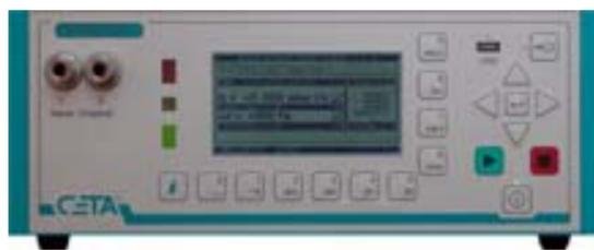
Die 2-Kanal-Variante des Cetatest 815 wird ab dem 3. Quartal 2011 verfügbar sein. Der Haupteinsatzbereich dieser Prüfgeräte ist die industrielle Dichtheitsprüfung in der Produktionslinie. Die technische Basis ist das 1-Kanal Ceta-
