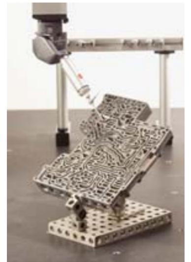
einer Werkstückoberfläche gleichzeitig in X-, Y- und Z-Richtung und damit automatisch in Richtung der Oberflächennormalen. Somit kann die Biegung des Taststiftes von der Messsoftware berechnet und kompensiert werden.
