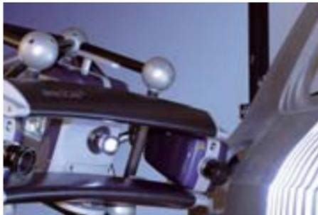
ne Messstation für Turbinenschaufeln b-INSPECT arbeitet mit einer robotergestützten Prüfteil-Zuführung. Eine im Vergleich zu anderen Systemen hohe Qualität bietet es bei der Inspektion von scharfen Kanten und kleinen Radien der Leading/Trailing Edges.
