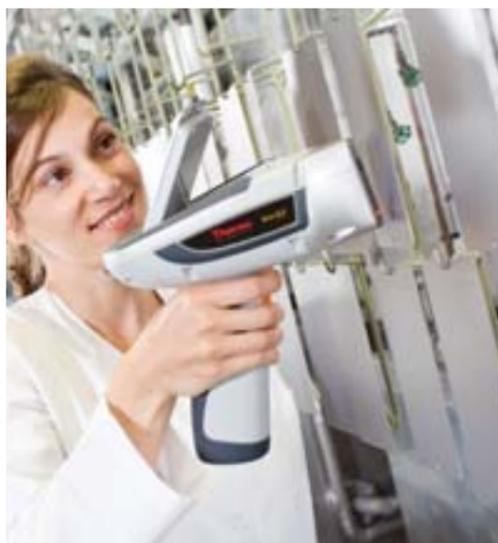
und Substraten bekannt. Mit der neuesten Software können jetzt auch Beschichtungsdicken und Beschichtungsgewichte gemessen werden. Damit ist das Gerät sofort einsetzbar zur Überprüfung der Effektivität von Beschichtungs- und Galvanisierungssystemen. Auch Galvanobäder können mit mobilen RFA-Analysatoren auf ihren Metallgehalt überprüft werden.
