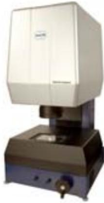
Bei entsprechender Konfiguration wird eine Längenmessabweichung von kleiner einem Mikrometer erreicht
