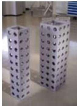
wird eine hohe Steifigkeit der Vorrichtungen sichergestellt. Aufgrund des durchgängigen Bohrungsrauers können die Einzelelemente beliebig zusammengefügt werden. Die Systemgröße Alufix 100 ist besonders vorteilhaft, da sie dem 100 mm-Netzplan entspricht.
