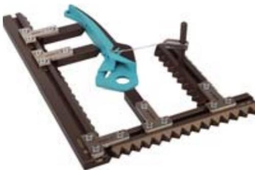
eine 3-Punkt Anlage herstellen, mit der man komplexe Teile sicher und reproduzierbar positionieren kann. Die Absicherung gegen Verrutschen erfolgt beispielsweise mit einem Federspanner. Die Anschlagzähne sind in zwei Längen verfügbar.
