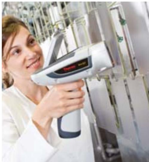
und Substraten bekannt. Mit der neuesten Software können jetzt auch Beschichtungsdicken und Beschichtungsgewichte gemessen werden. Damit ist das Gerät sofort einsatzfähig zur Überprüfung der Effektivität von Beschichtungs- und Galvanisierungssystemen. Auch Galvanobäder können mit mobilen RFA-Analysatoren auf ihren Metallgehalt überprüft werden.
